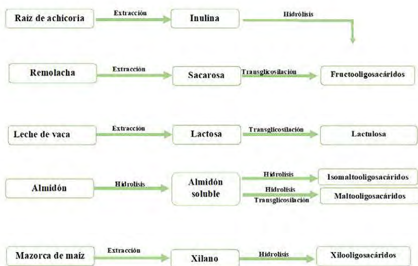
Figura 3. Procesos de extracción de diferentes prebióticos
