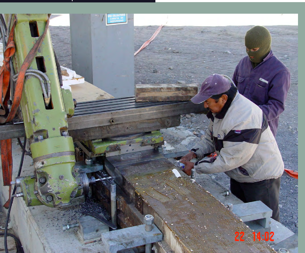
Figura 4. Maquinando el agujero para relevar esfuerzos.
