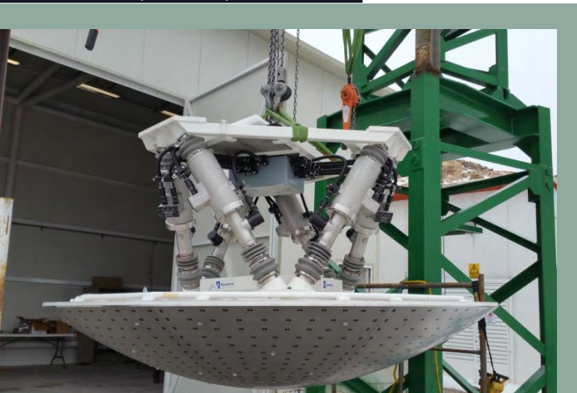
Figura 8. Espejo secundario y hexápodolistas para ser izados.
