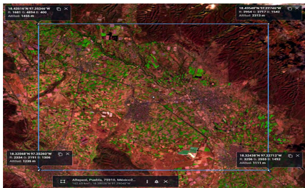
Figura 5.11: Análisis multiespectral en imagen de satélite de la ESA, sensor Sentinel 2 A , para determinar Análisis Multiespectral Del Index Stack de zonas semiáridas . Del tramo del ferrocarril 1. Con rumbo de San Pablo-Tepetzingo a Zinacatepec, Puebla. Se aprecian estadios de sequía y zonas semiáridas en tonos rojos claros y en rojo oscuro vegetación endémica y en verde cultivos. De fecha marzo del 2022.
