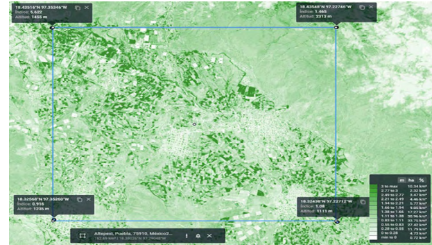
Figura 5.8: : Análisis multispectral en imagen de satélite de la ESA, sensor Sentinel 2 A , para determinar Enhanced vegetation index o Índice de Vegetación Mejorada (EVI) del tramo del ferrocarril 1. Con rumbo de San Pablo-Tepetzingo a Zinacatepec, Puebla. Se aprecia áreas de la Tierra con grandes cantidades de clorofila (como los bosques tropicales), y preferiblemente con efectos topográficos mínimos (regiones no montañosas). De fecha marzo del 2022.
