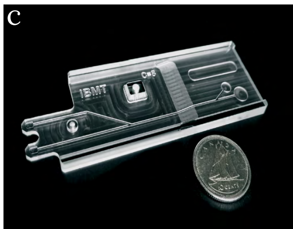
Figura 2. (A) Esquema del proceso de fabricación de microdispositivos en una máquina CNC a partir de diseños asistidos por computadora (CAD). (B) Fotografía que muestra una máquina CNC en funcionamiento. (C) Fotografía de un dispositivo de acrílico que contiene grabado una variedad de geometrías y tamaños. Tomado de Guckenberger et al., 2015
