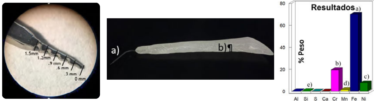
Figura 3. A.- Sonda periodontal: a) Punta metálica con angulación de 135° y 3 cm de largo, b) Mango de acrílico de 15 cm de largo, grosor 1.5 cm. B.- Punta activa de la sonda, imagen obtenida con microscopio estereoscópico, a) Graduación de 1.5 mm, b) Muecas separadas por 0.3 mm y C.- Aleación de la punta activa de la sonda: compuesta en su mayoría por a) Hierro, b) Cromo y c) Níquel. En minoría por d) Manganeso y e) Sílice. (Fuente: Laboratorio Multidisciplinario, Facultad de Estomatología, BUAP).
