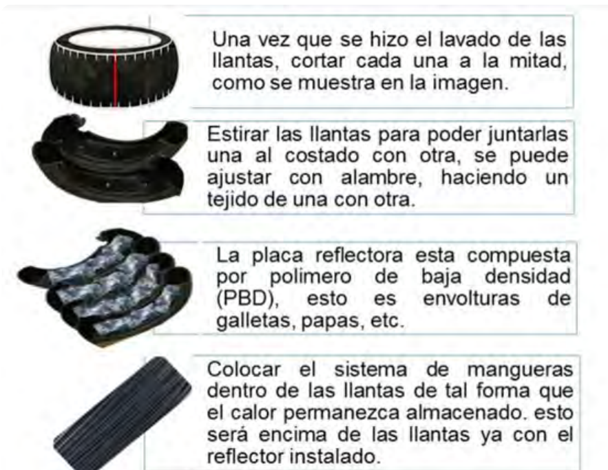
Figura 2: Diagrama de proceso del diseño del colector solar de neumático
