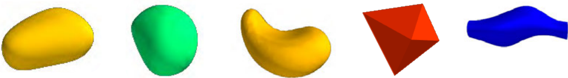
Figura 6. Morfologías obtenidas a partir de los datos de la Tabla 2, presentado formas de a) óvalo, b) pseudo-esfera, c) tipo nuez, d) octaedro, y e) tipo tubo.
