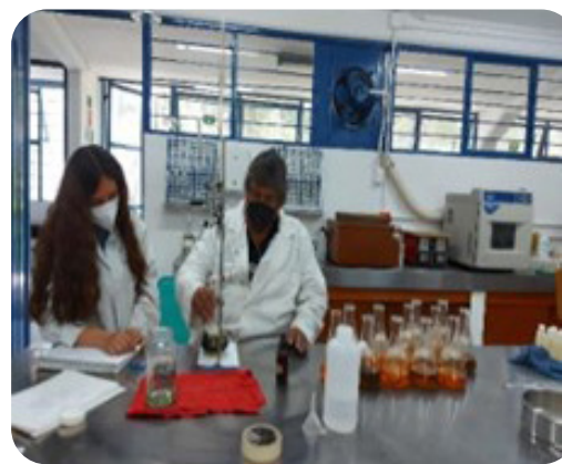
Figura 11. Determinación de materia orgánica en muestras de suelo.
