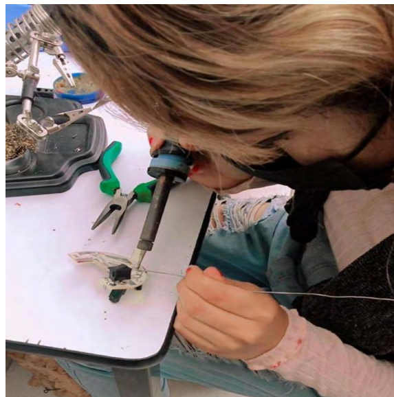
Figura 7. Soldando componentes electrónicos a la etapa de potencia
