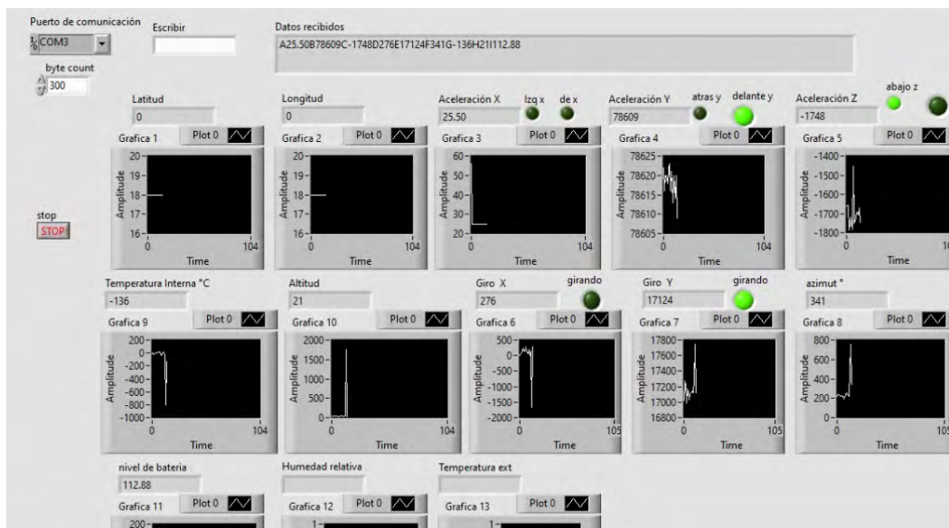
Figura 14. Recepción y gráficas de datos en estación terrena
