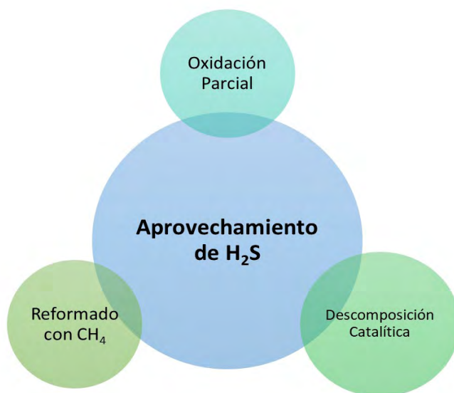
Figura 5.6. Principales metodologías para el aprovechamiento de \text{H}_2\text{S}
